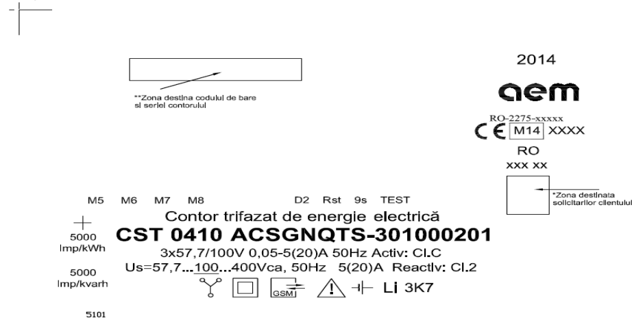
Fig 3. Placa de identificare pentru varianta de conectare directă în circuitele de tensiune, interfață serială RS232 și buclă de curent
